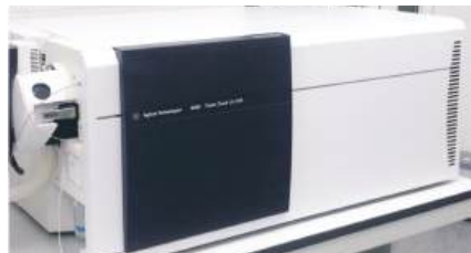
Хроматограф жидкостный Agilent 1260 Infinity (US83870021) с Triple Quadrupole 6460A LC/MS System
