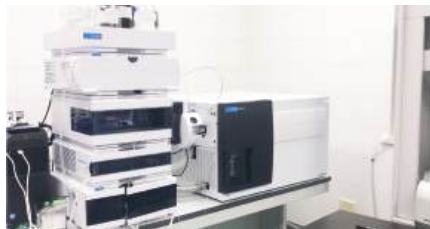
Хроматограф жидкостный Agilent 1260 Infinity II (SG2111G206) с Triple Quadrupole 6470 LC/MS System
